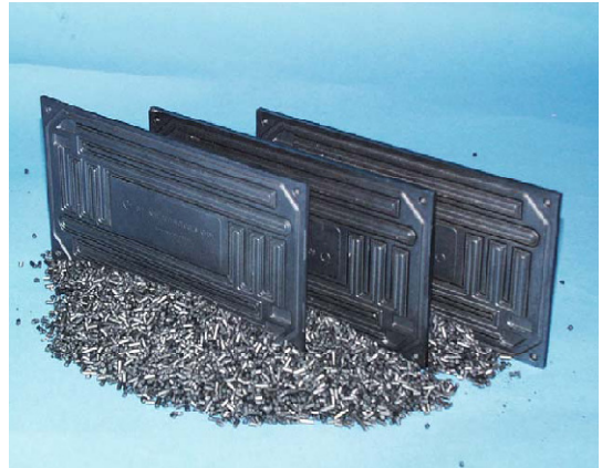
Şekil 4.2. SGL şirketi tarafından enjeksiyon kalıplama ile üretilmiş bipolar plakalar ve granüller (@Sigracet PPG86-@Sigracet BBP4)
