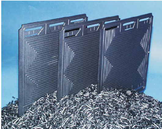
Şekil 4.2. SGL şirketi tarafından enjeksiyon kalıplama ile üretilmiş bipolar plakalar ve granüller (@Sigracet PPG86-@Sigracet BBP4)
