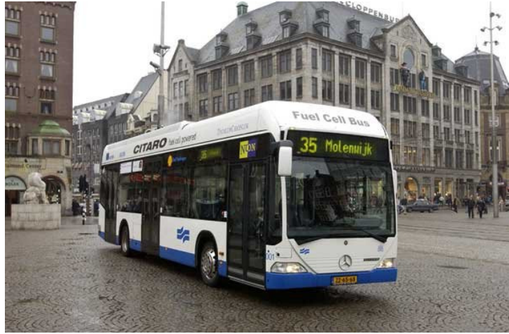
Şekil 2.4. Yakıt hücresi ile çalışan bir belediye otobüsü (Mercedes CITARO)
