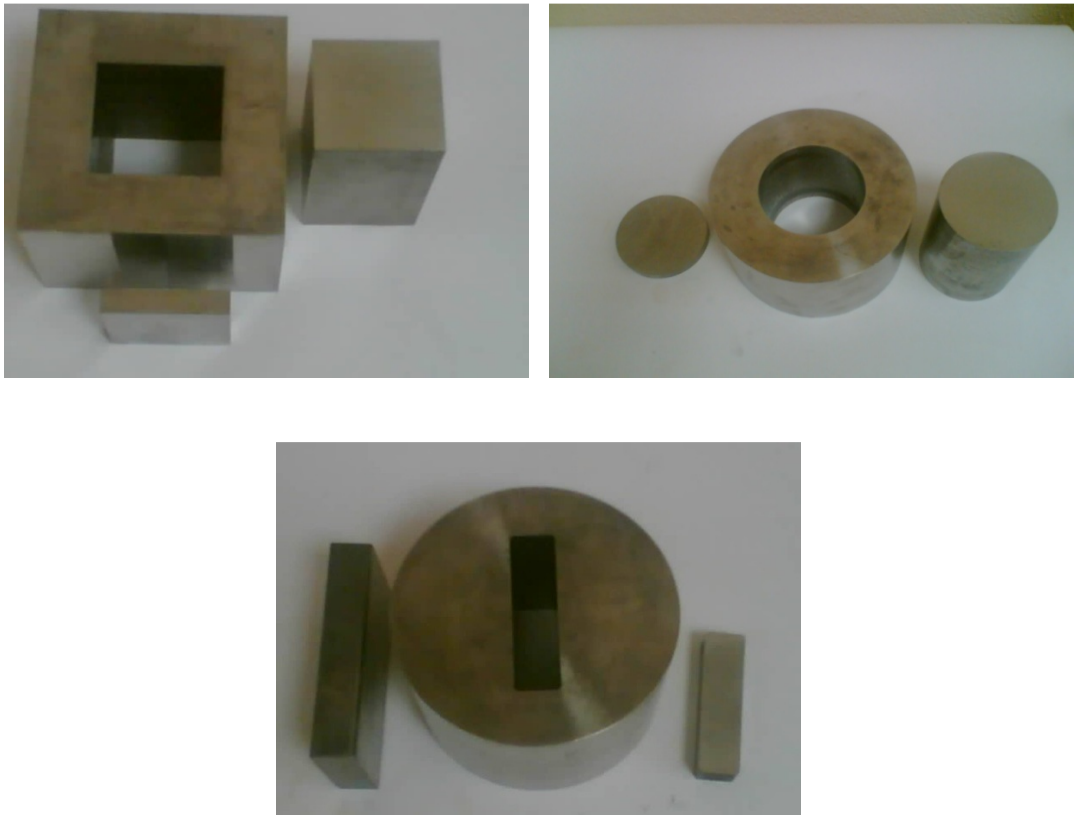
Şekil 4.4. Farklı boyutlarda ve şekillerde çelikten imal edilmiş kalıplar
