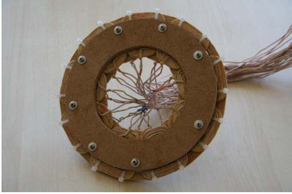
Şekil 4.9 Üretimi yapılan statorun sargıları
