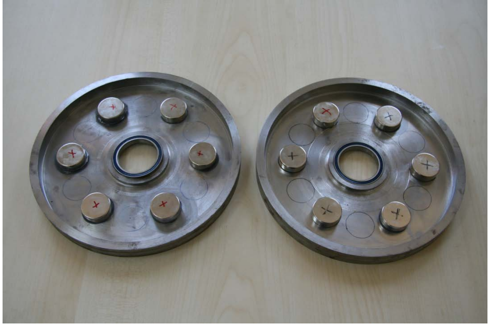
Şekil 4.4 N Kutuplu Mıknatıslar Yerleştirildiğinde
