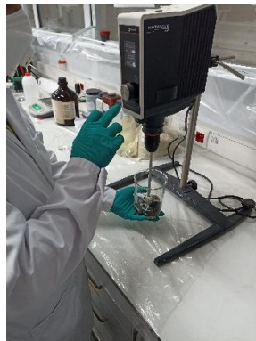
Şekil 4.7: Kuru olarak 100 rpm'de karıştırılmış numune.
