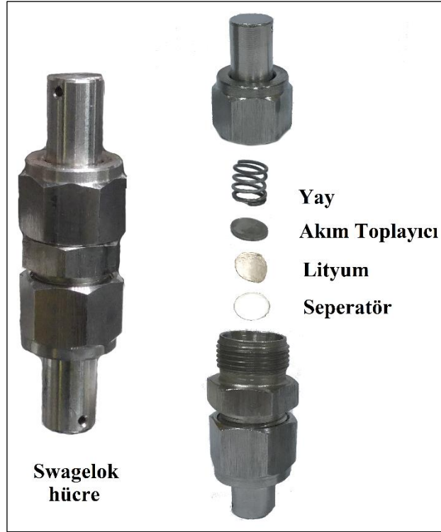
Şekil 5.1: Swagelok™ türü hücrelerin oluşturulma süreci.
