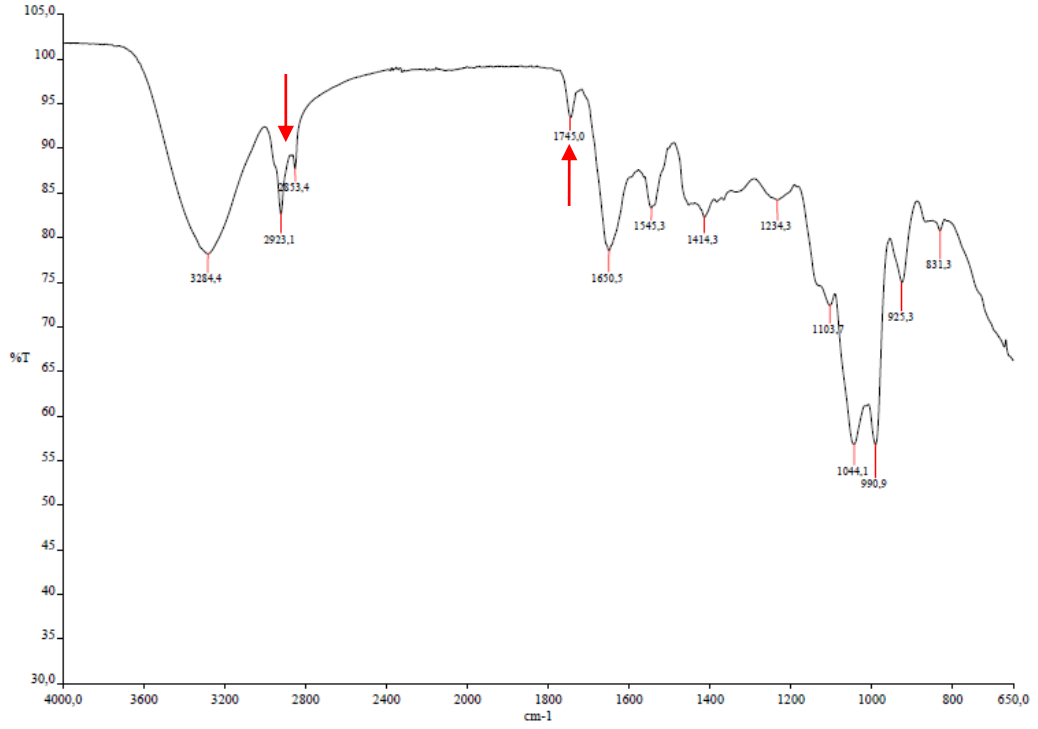
Şekil 5.21: R2YE besiyerinde 72 saat inkübe edilen A3(2) yabancı tip şuşunun FTIR analiz sonucu. Oklar 2959 ve 2852 \text{cm}^{-1} arasında yer alan C-H ve 1740 \text{cm}^{-1} yakınında bulunan C = O ester germe bandını göstermektedir.
