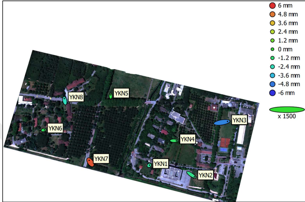
Şekil 5.9: YKN dağılımı ve hata elipsleri.
