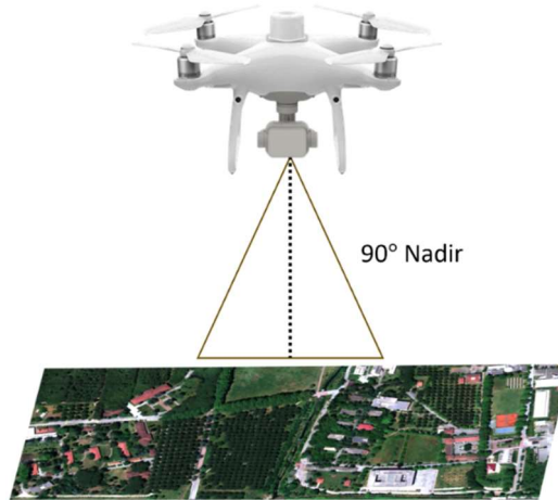
Şekil 5.1: Görüntü alımı kamera açısı.
