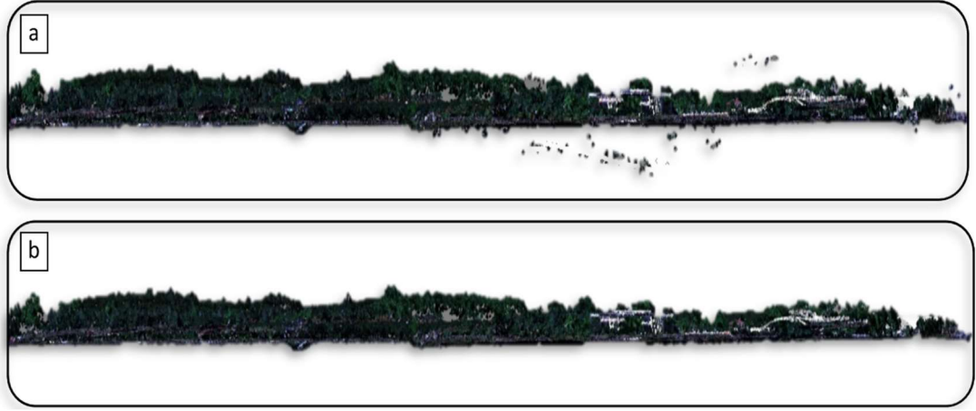
Şekil 5.13: Filtreleme işlemi uygulanmamış (a) ve uygulanmış (b) nokta bulutu.
