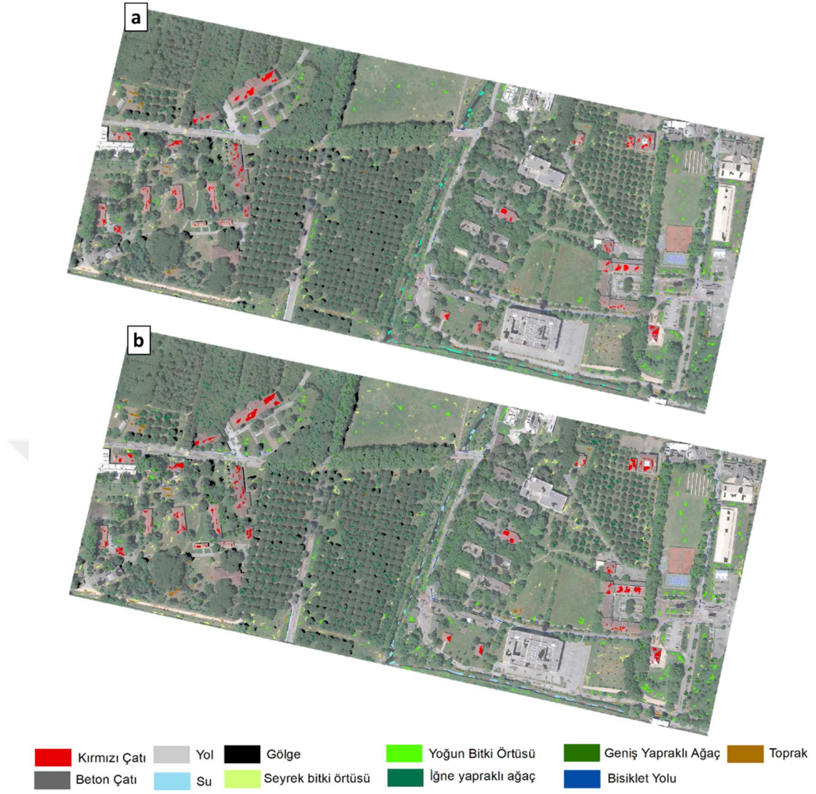
Şekil 5.24: 5-bant (a) ve 6-bant (b) segmentasyon sonuçları için tüm sınıflara ait örnek veriler.
