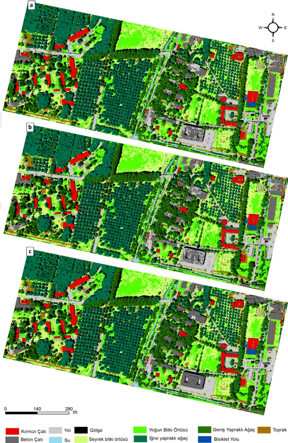
Şekil 5.27: 6 bantlı ortomozaik veri ve RF algoritmasının kullanımıyla V1 (a), V2 (b), V3 (c) veri setleri için üretilen tematik haritalar.
