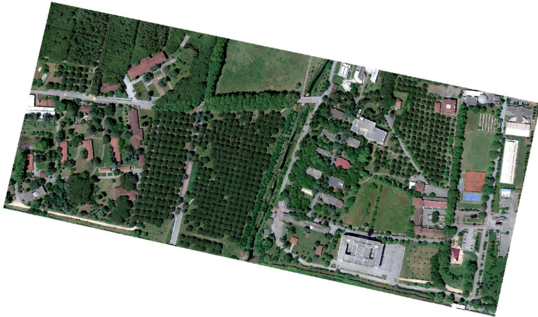
Şekil 5.17: Radyometrik kalibrasyon uygulanmış 5-bantlı ortomozaik.
