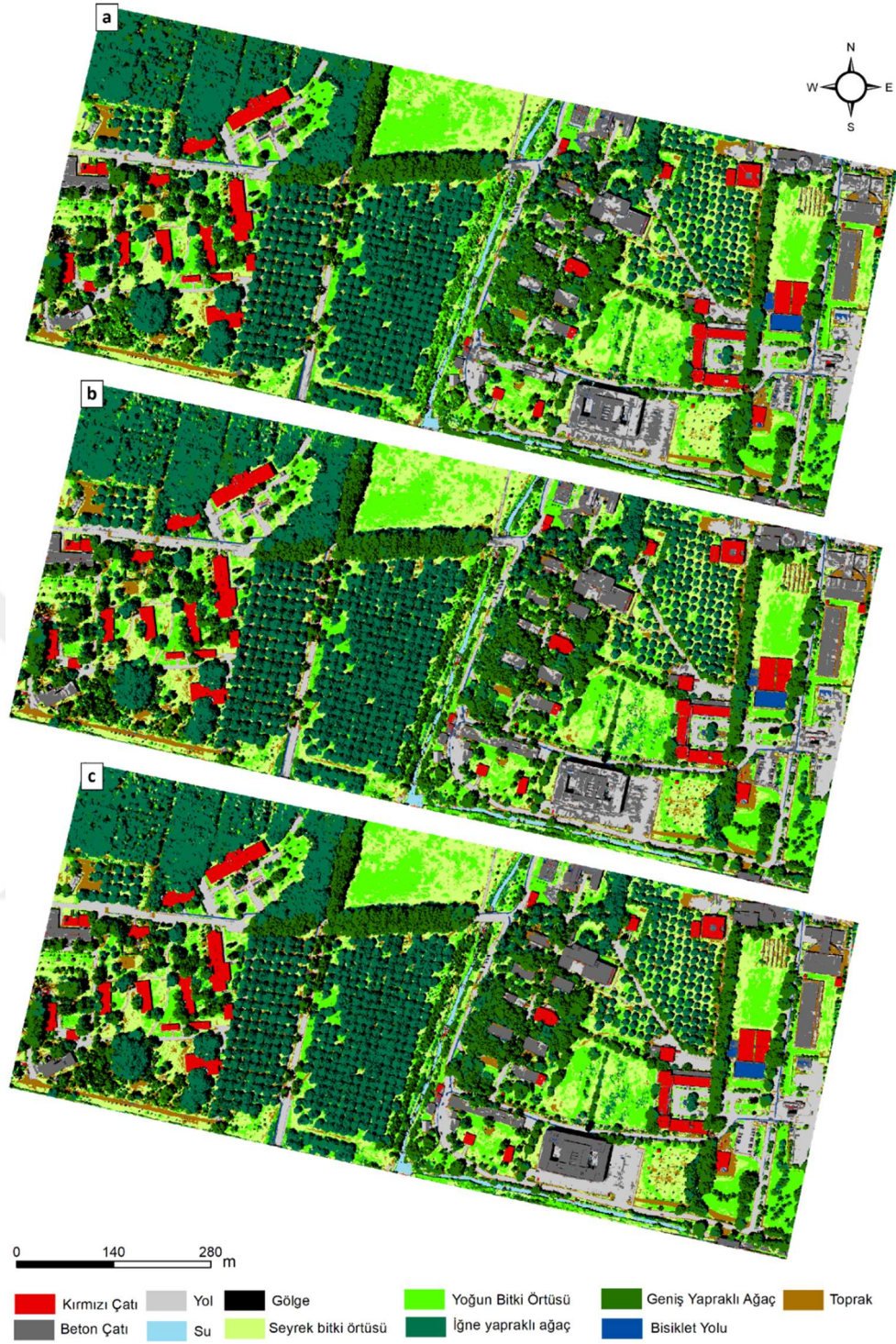
Şekil 5.32: 6-bantlı ortomosaik veri ve SVM algoritmasının kullanımıyla V1 (a), V2 (b), V3 (c) veri setleri için üretilen tematik haritalar.
