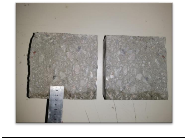
Şekil B1.5: C5520K kodlu numunenin su sızdırmazlık derinliğinin resimsel olarak gösterimi.
