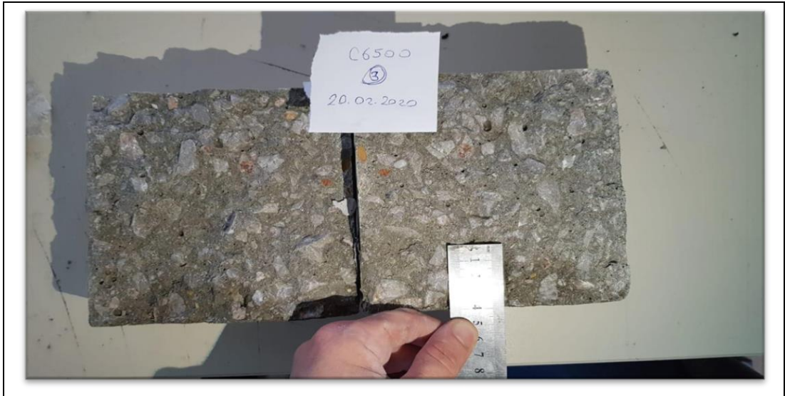
Şekil 2.5: Su geçirimsizlik derinliği ölçülen numune.
