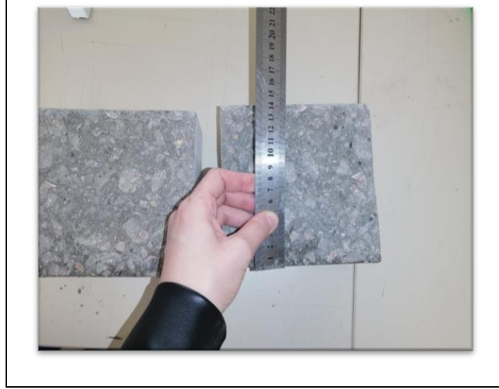
Şekil B1.2: C5500 kodlu numunenin su sızdırmazlık derinliđinin resimsel olarak gösterimi.
