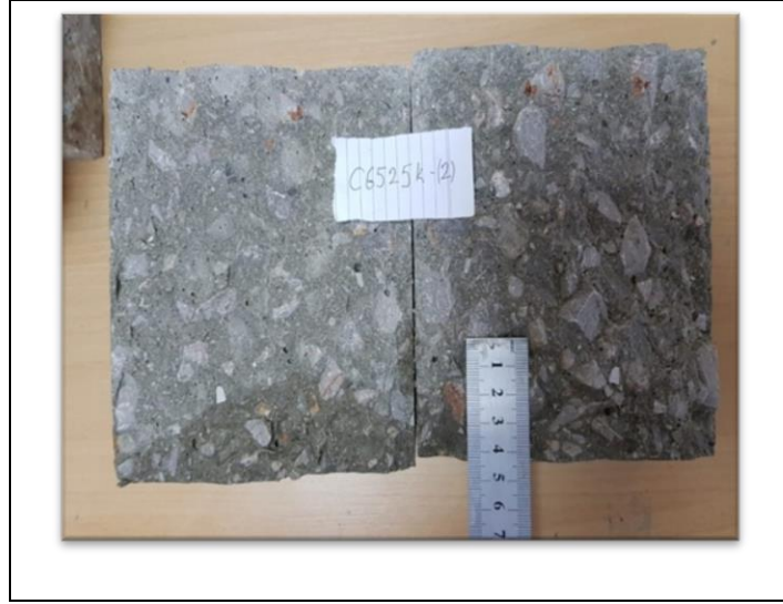
Şekil B1.6: C6520K kodlu numunenin su sızdırmazlık derinliğinin resimsel olarak gösterimi.
