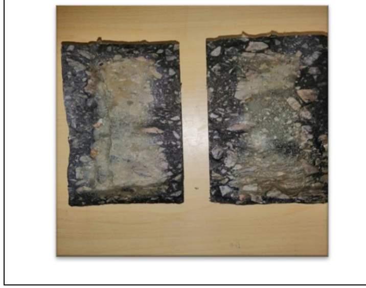
Şekil A1.7: C4500 kodlu numunenin yaklaşık 300 günlük klorür derinliğinin resimsel olarak gösterimi.
