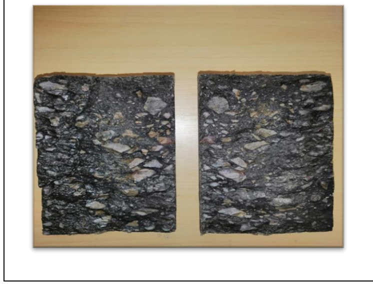
Şekil A1.9: C6500 kodlu numunenin yaklaşık 300 günlük klorür derinliğinin resimsel olarak gösterimi.
