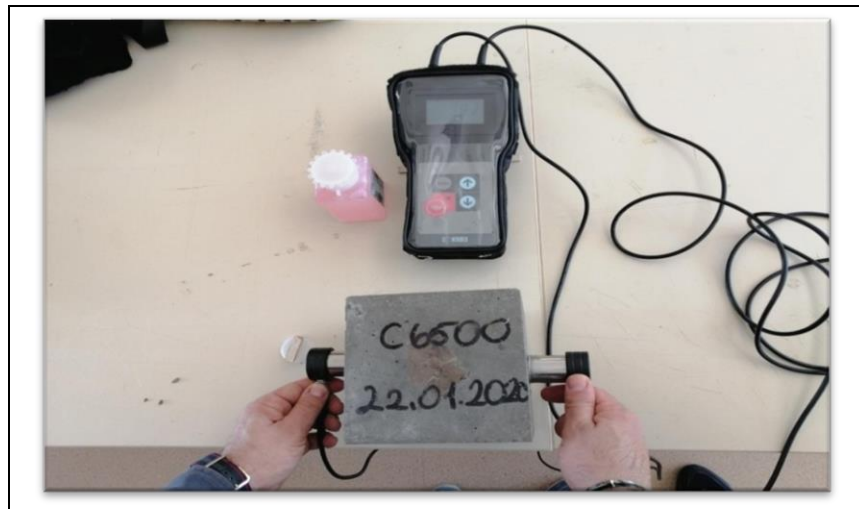
Şekil 2.10: Ultrases geçiş süresi ölçümü.
