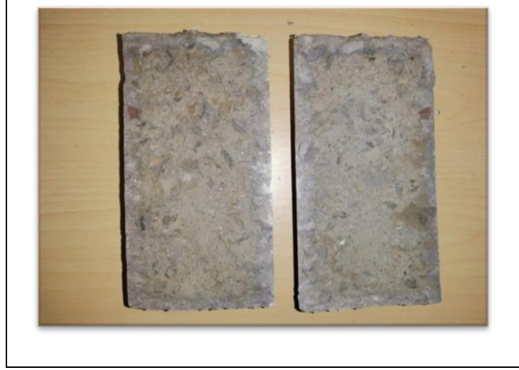
Şekil A1.5: C5520K kodlu numunenin 28. günlük klorür derinliğinin resimsel olarak gösterimi.
