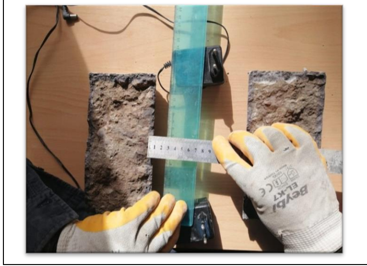
Şekil A1.3: C6500 kodlu numunenin 28. günlük klorür derinliğinin resimsel olarak gösterimi.
