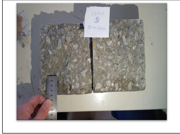
Şekil B1.3: C6500 kodlu numunenin su sızdırmazlık derinliğinin resimsel olarak gösterimi.
