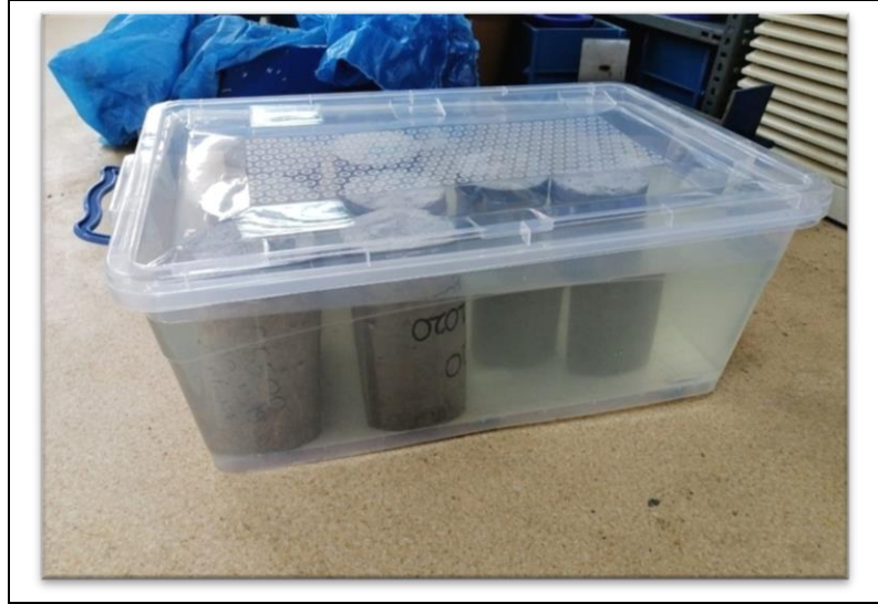
Şekil 2.8: %3.5 NaCl çözeltisinde bekletilen numuneler.
