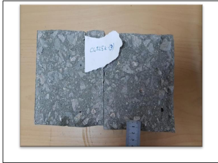
Şekil B1.4: C4520K kodlu numunenin su sızdırmazlık derinliğinin resimsel olarak gösterimi.
