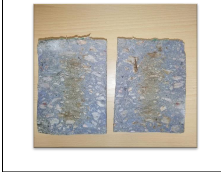
Şekil A1.8: C5500 kodlu numunenin yaklaşık 300 günlük klorür derinliğinin resimsel olarak gösterimi.
