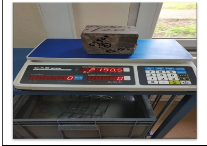
Şekil 2.6: Yüzey kuru suya doygun kütle.
