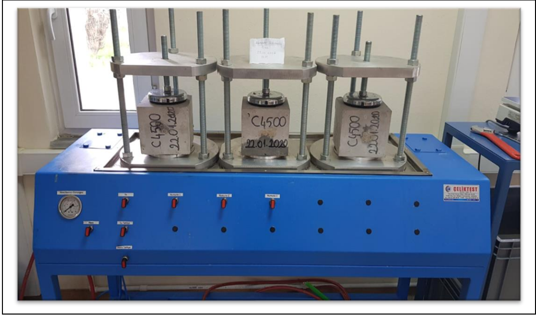
Şekil 2.4: Su geçirimsizlik deneyi uygulanan küp numuneler.
