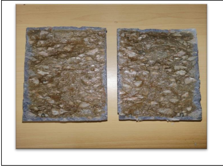
Şekil A1.4: C4520K kodlu numunenin 28. günlük klorür derinliğinin resimsel olarak gösterimi.
