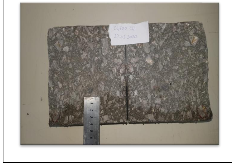
Şekil B1.1: C4500 kodlu numunenin su sızdırmazlık derinliđinin resimsel olarak gösterimi.
