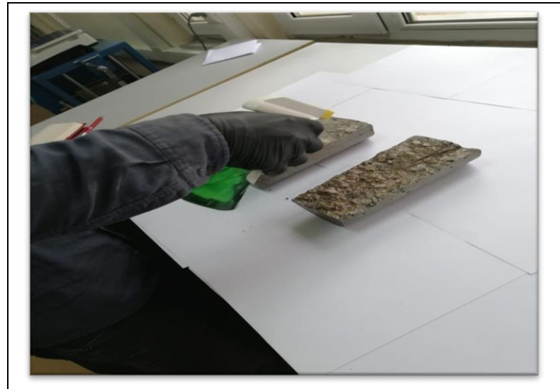
Şekil 2.9: 0.1 M AgNO 3 çözeltisi uygulanan numune.
