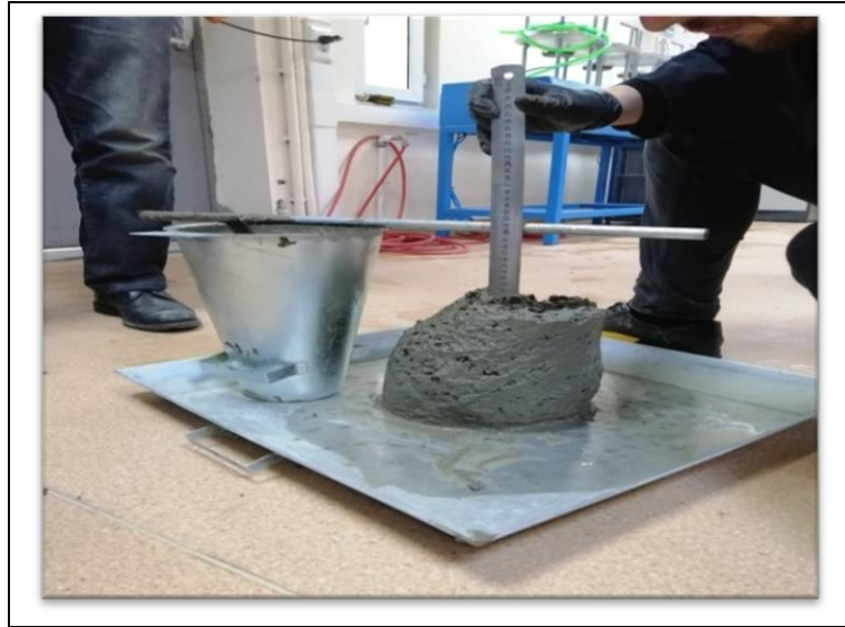
Şekil 2.11: Betonda çökme değerinin ölçümü.
