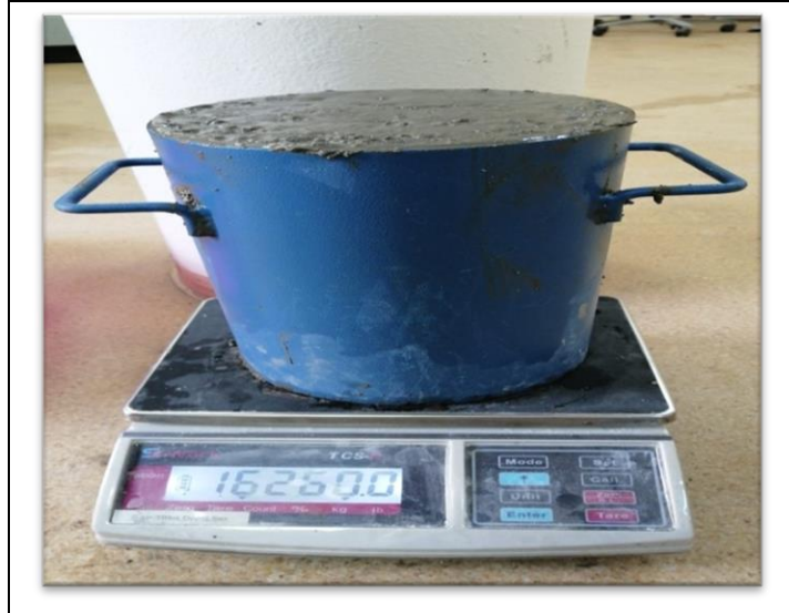
Şekil 2.12: Betonda net ağırlığın ölçülmesi.
