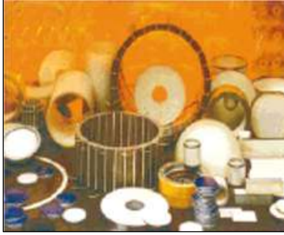
Şekil 2.7: Sonar, hızlandırıcılar (accelerometers), eyleyiciler (actuators), ve sensörler gibi piezoelektrik ve elektrostriktif uygulamalarda kullanılan çeşitli ferroelektrik seramikler.
