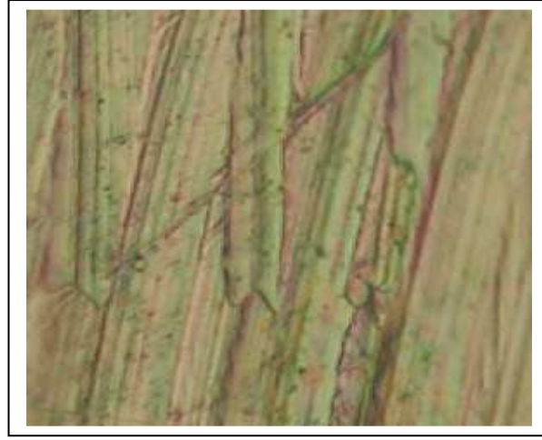
Şekil 4.3. Frezeleme işleminden elde edilen yüzey dokusu
