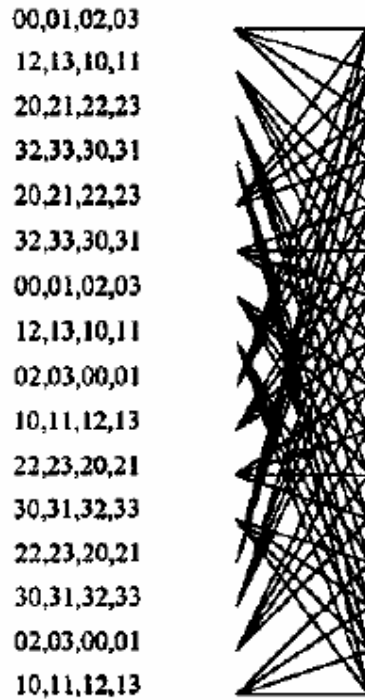
Şekil 7.2 16 durumlu, 4 FKA, 1/2 oranlı kafes kodun yapısı.
