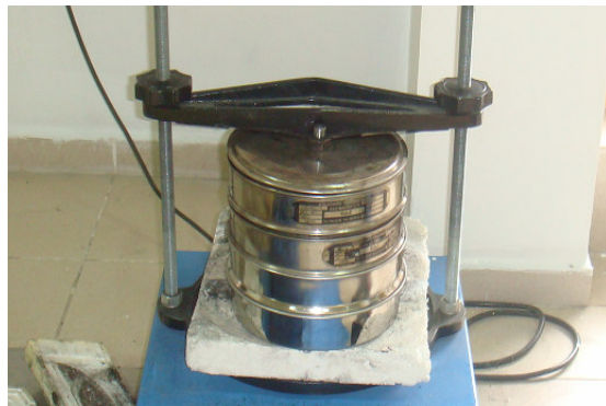
Şekil 4.1. Çalışmada kullanılan kömür örneğinin eleklerden geçirilmesi.
