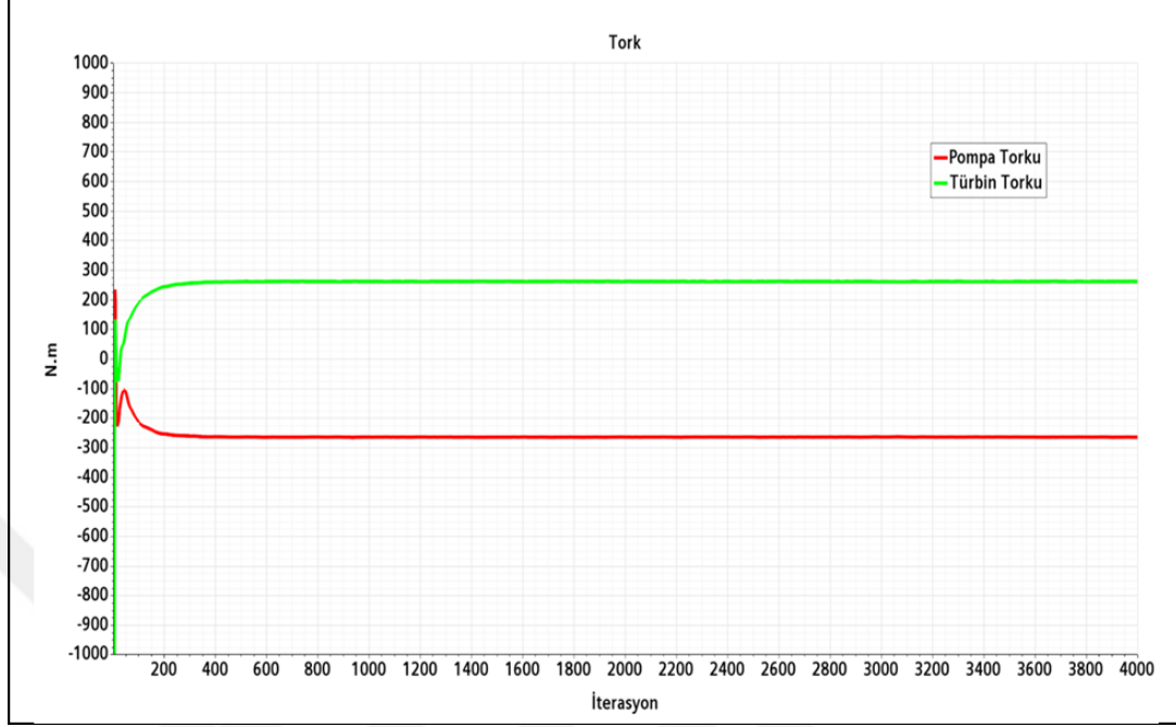
Şekil 4.35: k-w SST Türbülans Modeli Kullanarak Elde Edilen Tork Değeri (H.O. = 0.8).
