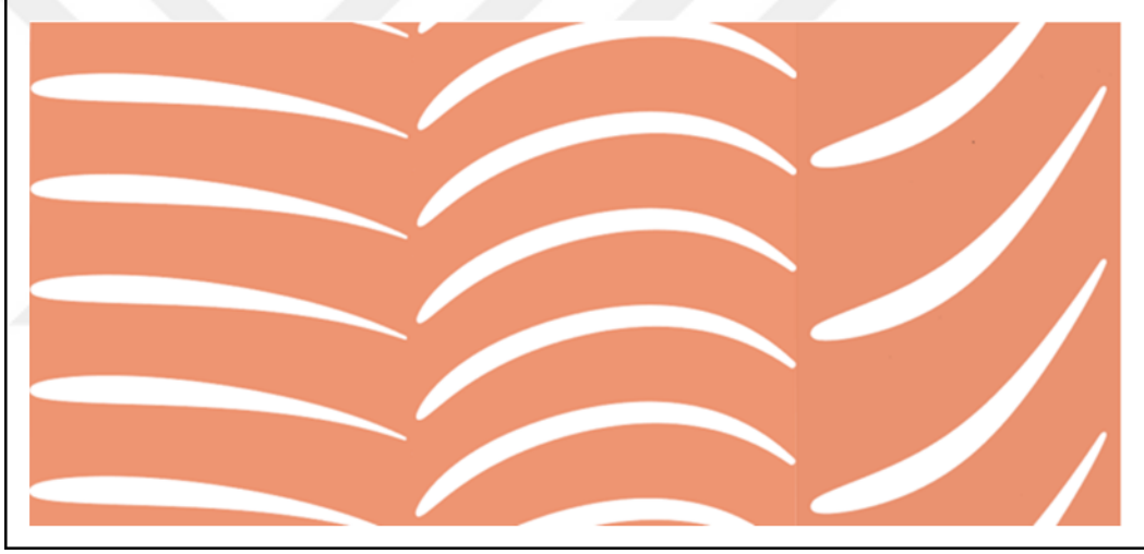
Şekil 4.3: Tork Konvertör Kanat Kesitleri (Soldan Sağa Pompa, Türbin ve Stator).
