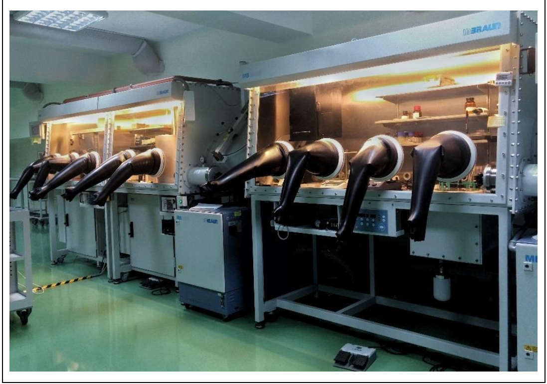
Şekil 3.7: OLED aygıt yapımında kullanılan eldivenli kutu sistemi.
