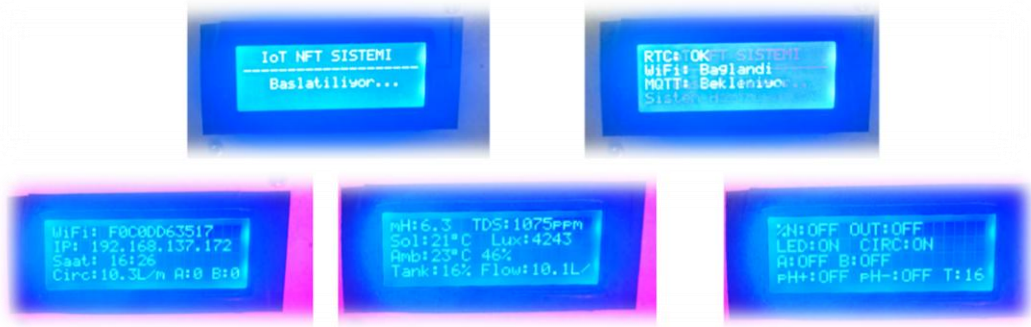
Şekil 5.1: Sistem açılış ekranı ve LCD üzerinde döngüsel veri gösterimi.
