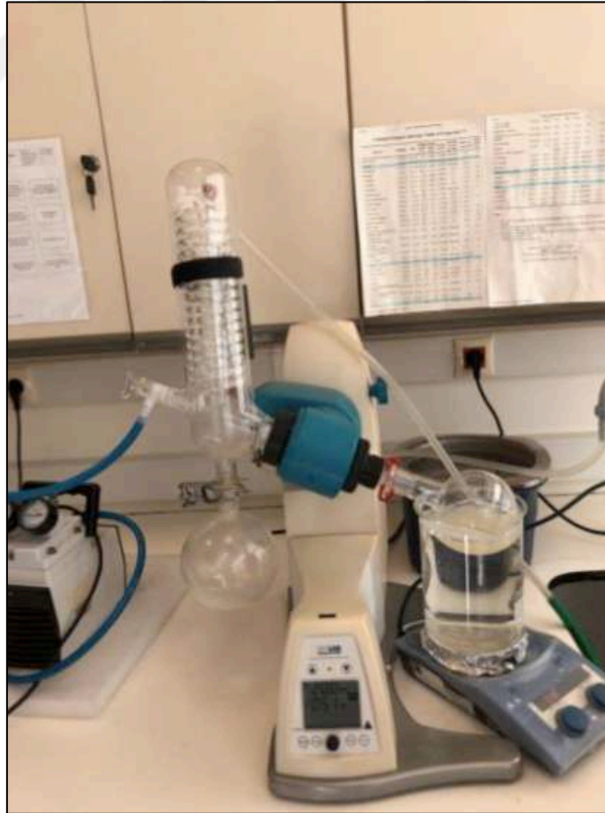
Şekil 4.3: Döner buharlaştırıcı ile kloroformun uzaklaştırılması
