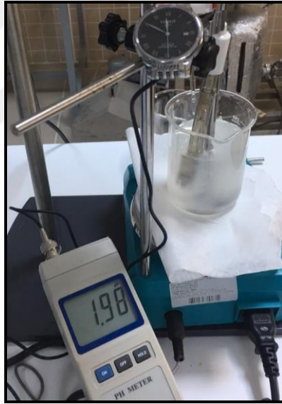
Şekil 4.3: Sodyum silikat eklenirken yapılan pH ölçme işlemi.
