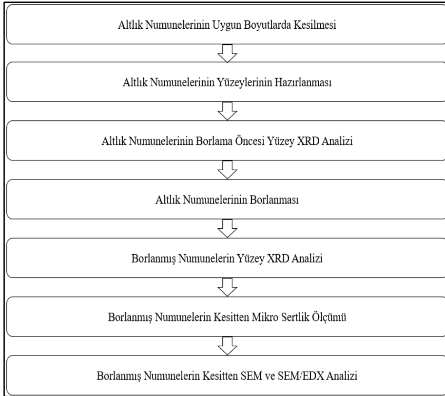
Şekil 4.1: Deneysel çalışmaların akış diyagramı.
