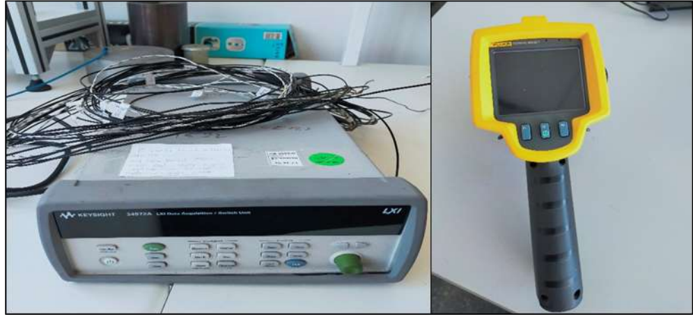
Şekil 4.3: Sıcaklık ölçer ve termal kamera.
