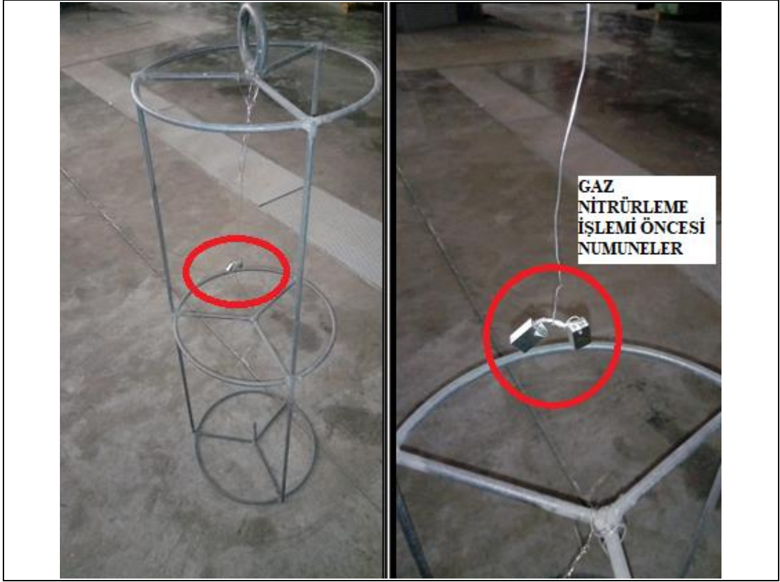
Şekil 5.3: Gaz nitrürleme işlemi öncesi numunelerin fırın sepetine asılmasını gösteren tipik bir fotoğraf.
