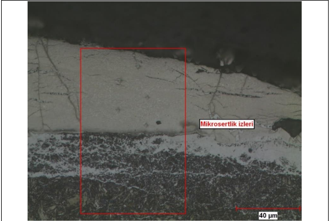
Şekil 6.8: ESD yöntemiyle Ti kaplanmış ve üzerine gaz nitrürleme işlemi uygulanmış numune(TiGN)'nin mikrosertlik izlerinin optik mikroskop görüntüsü.
