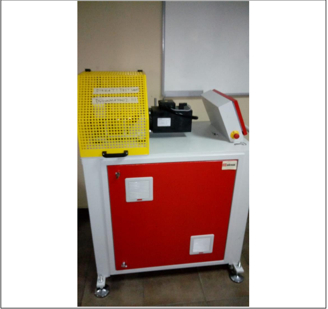
Şekil 5.7: “Block on ring” aşınma test cihazı.
