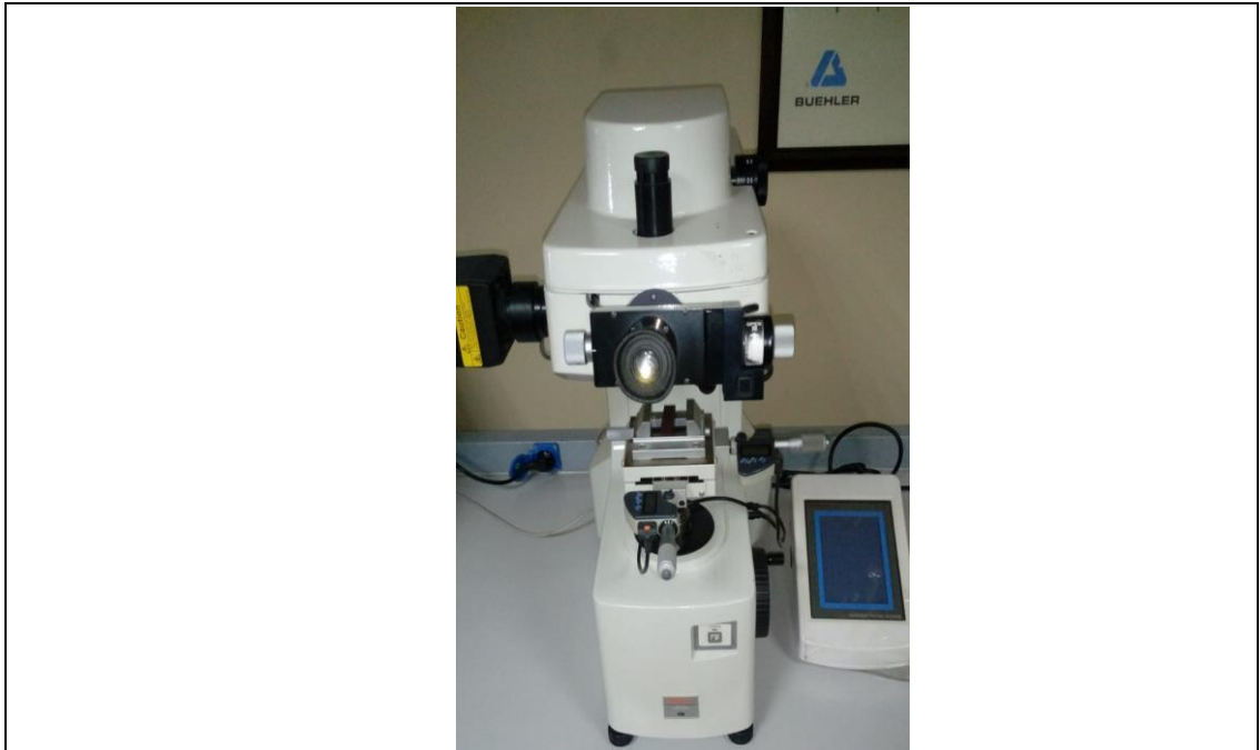
Şekil 5.5: Mitutoyo HM-112 mikrosertlik ölçme cihazı.
