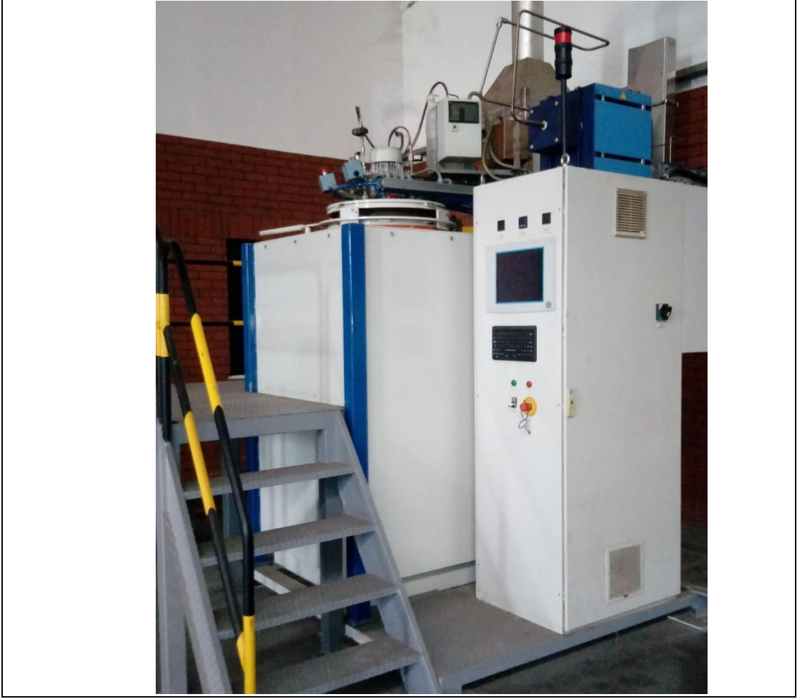
Şekil 5.2: Nitrex 412S atmosfer kontrollü gaz nitrürleme fırını.
