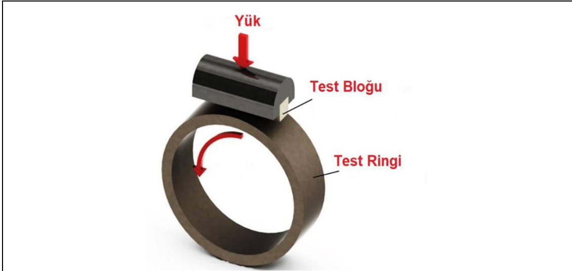
Şekil 5.6: Block on ring aşınma test sisteminin şematik gösterimi.
