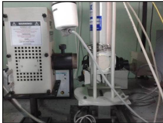
Şekil 3.3: Soldaki cihaz ısı uyarılmış akım ölçümlerinde kullanılan Thermo Oriel Xenon ışık kaynağı ve sağdaki cihaz da kapalı sistem bir helyum pompası ile soğutulan ölçümlerin gerçekleştirildiği kroyostat.
