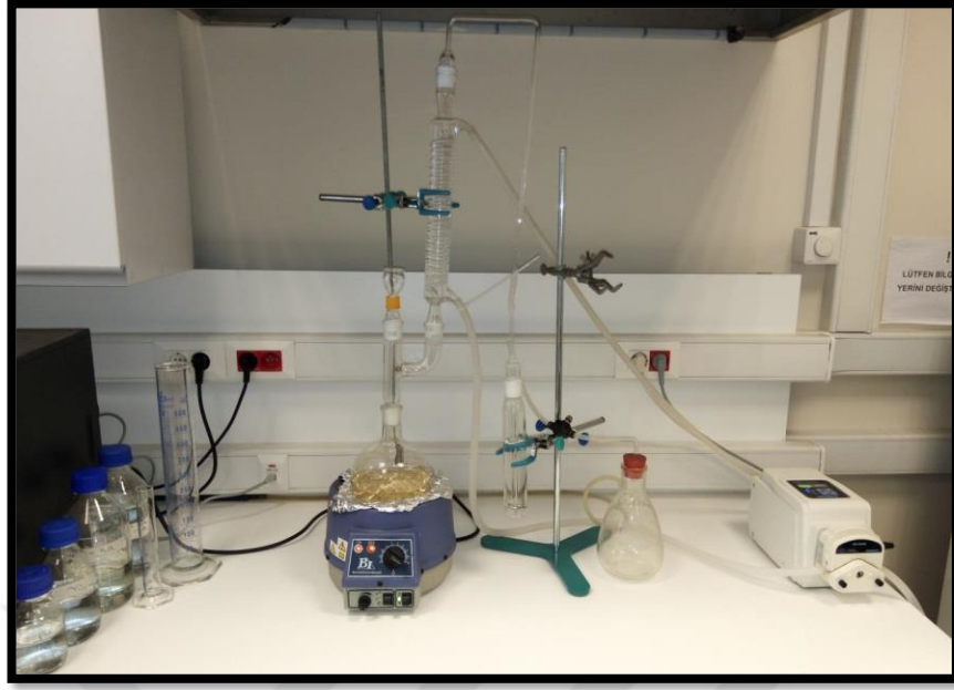
Şekil 3.3: Toplam CN analizi için kullanılan distilasyon sistemi.
