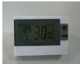
Şekil 7.2. Hücre içerisindeki bağıl nemin kontrolü için kullanılan TFA marka termo- higrometre.
