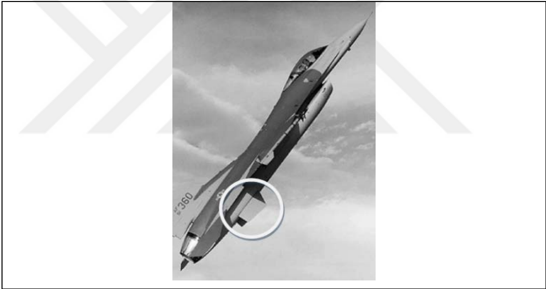
Şekil 2.16: F16 gövde arkası kanatları (Metal Matris Kompozit).
