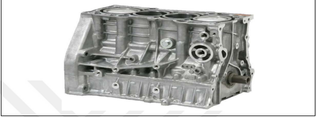
Şekil 2.17: Metal matrisli kompozit ile üretilen motor bloğu.
