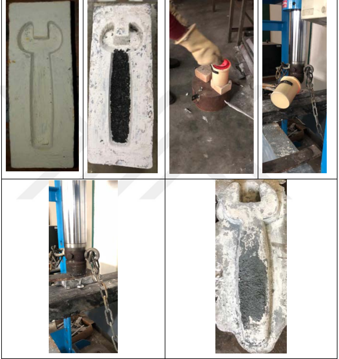
Şekil 4.3: Kompozit üretiminin işlem basamakları.
