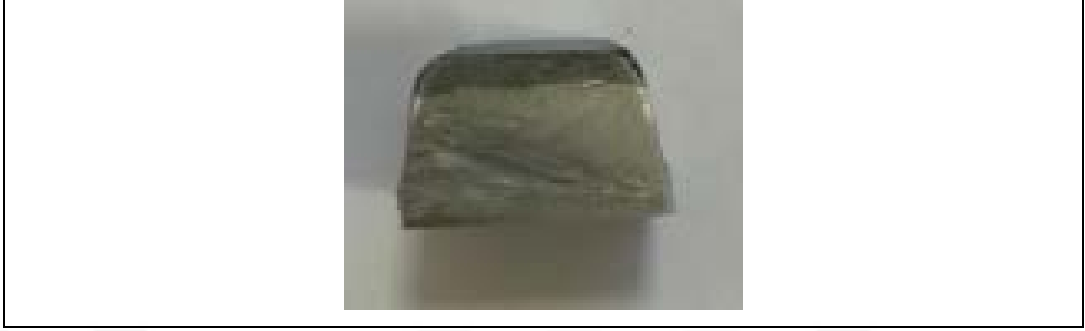
Şekil 4.4: 2 mm katlandırılarak dökme demir talaşı takviyesi üretilen kompozit malzemeden incelenen aşınma, SEM, optik mikroskop numuneleri.
