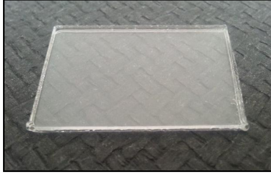
Şekil 4.10: Lazer kesim cihazı ile kesilen Polistiren petri kabı.
