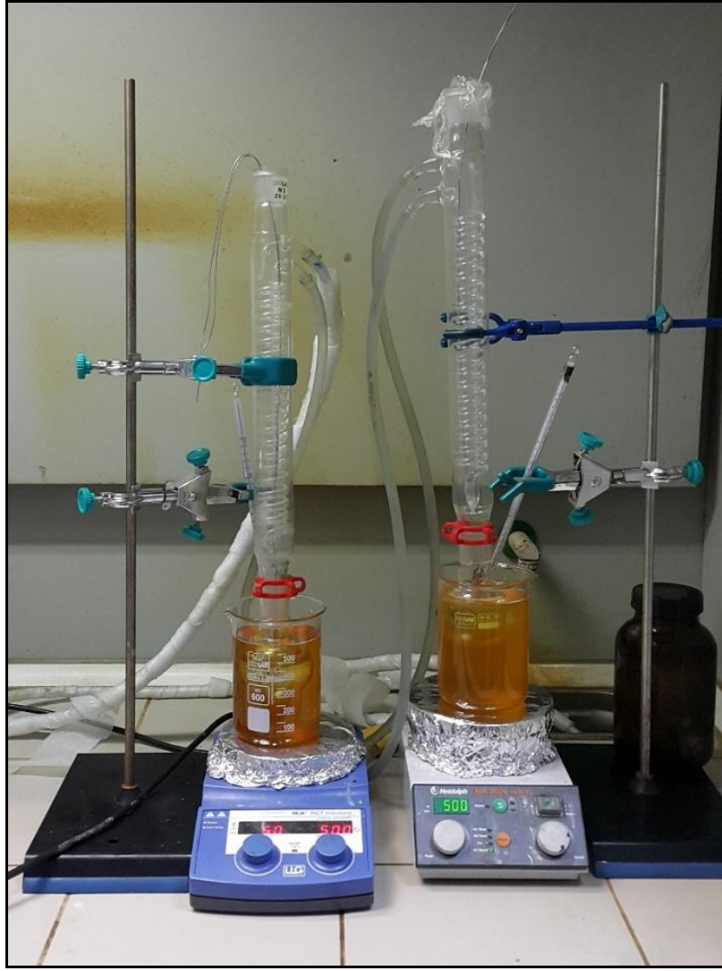
Şekil 4.14: Organosilan ısıtılarak sıvı faz kaplama deney düzeneği.
