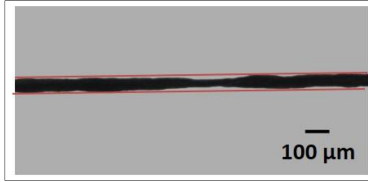
Şekil 5.12: 27G enjektör ucu ile elde edilen GO ipliğe ait bir mikroskop görüntüsü.
