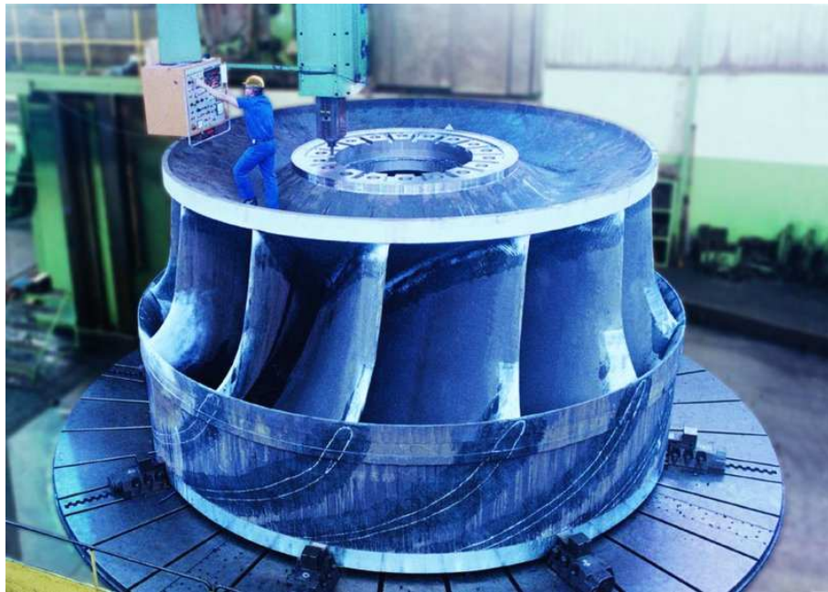
Şekil 3.4. Francis türbini çarkı [14].
