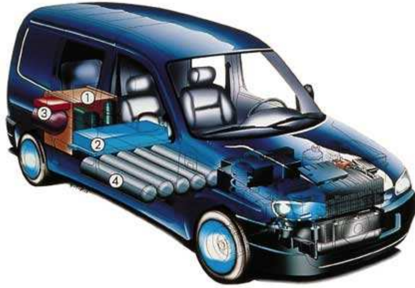
Şekil 2.9. PSA Peugeot Citroen tarafından Partner / Berlingo modeli olarak, CEA ve endüstriyel ortakları tarafından geliştirilen yakıt pilli araç prototipi. Ana hücre (1) , DC / DC elektrik dönüştürücüleri (2), hidrojen dolaşım devresi (3), ve yüksek basınçlı hidrojen tankı (4).
