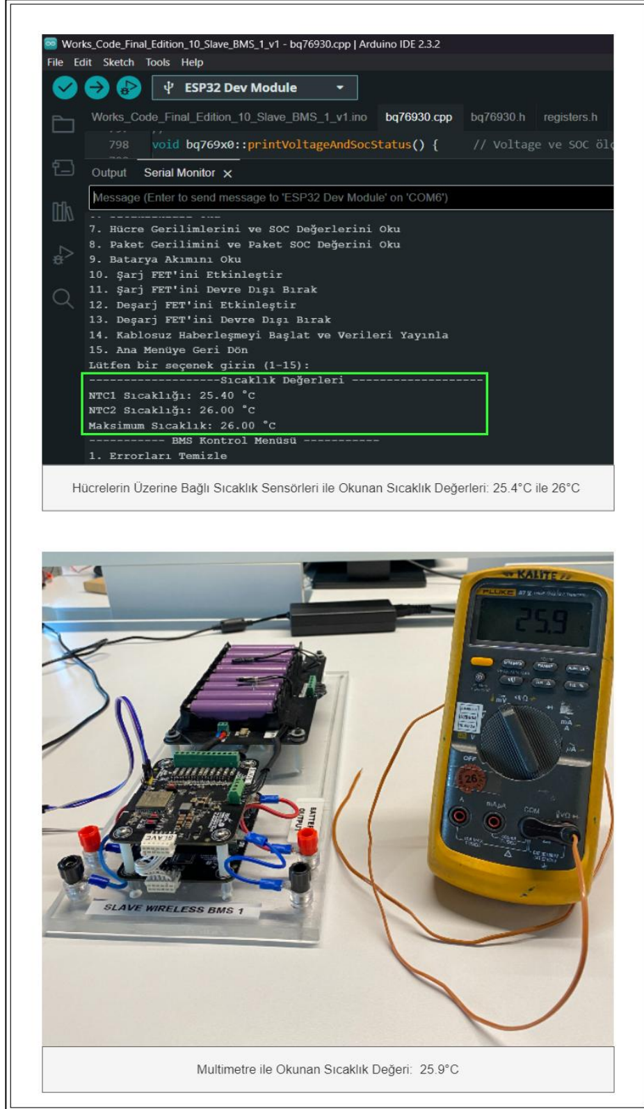
Şekil 5.27: Sıcaklık okuma testi.
