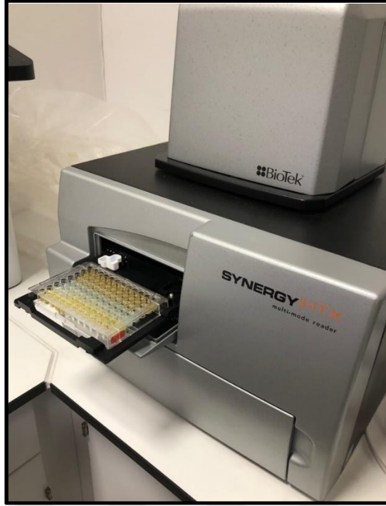
Şekil 3.6.1.2: Spektrofotometre ile absorbans ölçümü.
