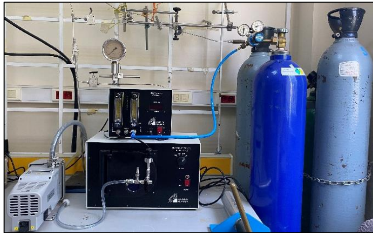
Şekil 3.5: Oksijen Plazma Cihazı (Harrick Plasma Cleaner)
