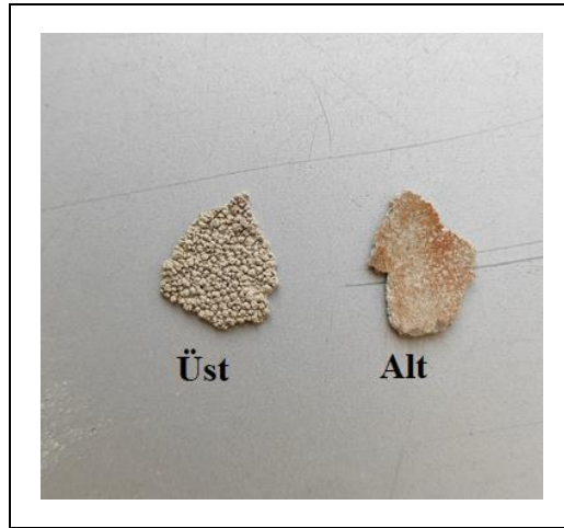
Şekil 3.17: Gaz motorunda oluşan depozitin alt ve üst görünümü.
