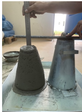
Şekil 3.5: Çökme deney düzeneği.
