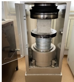
Şekil 3.17: Basınç dayanımı deney düzeneği.
