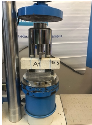
Şekil 3.15: Eğilme dayanımı deneyi.
