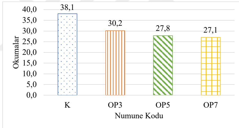
Şekil 4.16: Beton numunelerde Schmidt okumaları.
