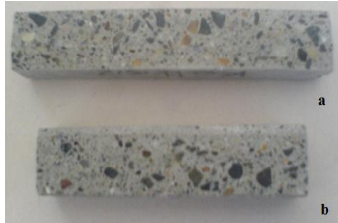
Şekil 3.8 (a)- Kompoze çimento (KÇ)'lu frit katkısız (b)-%5 Frit Katkılı elastik modül ölçüm çubukları
