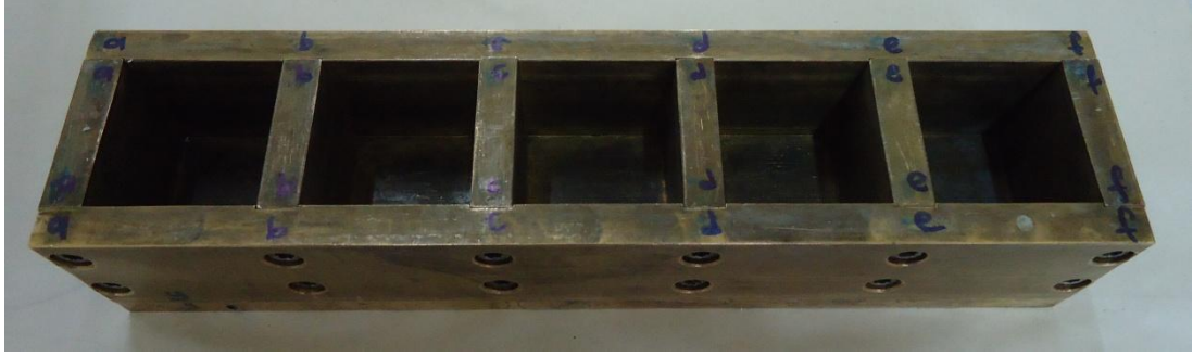
Şekil 3.4 Frit katkılı kürlü ve kürsüz, Kompoze çimento (KÇ)'lu frit katkısız kürlü ve kürsüz olarak hazırlanan beton karışımlarının şekillendirilmesinde kullanılan kalıp
