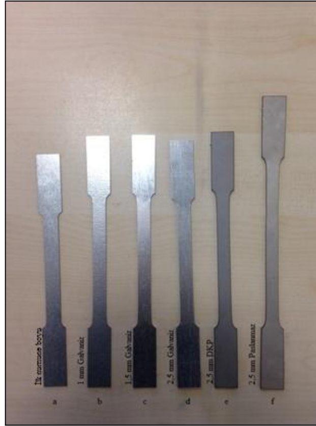
Şekil 5.3: Çekme testi öncesi ve boyun verme noktasına kadar yüklenen numune boyları.
