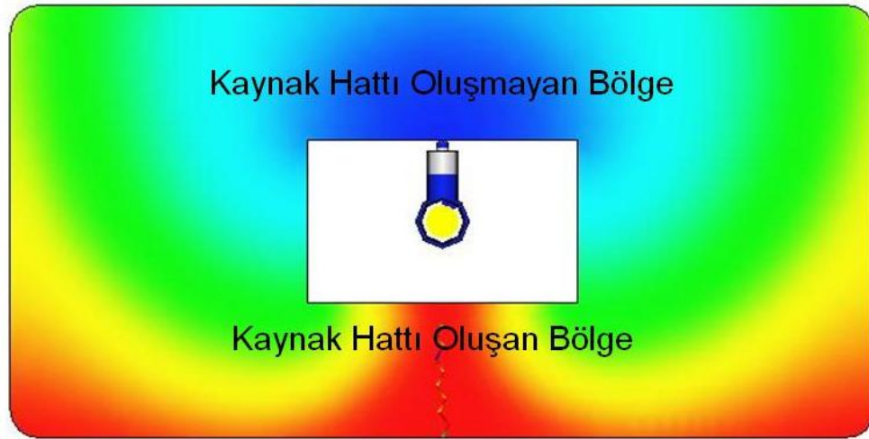
Şekil 6.7. Engel Açısı 0^\circ Olan Parçada Kaynak Hattı Oluşan ve Oluşmayan Bölgeler.
