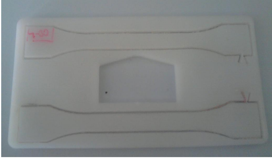
Şekil 6.35. Su Jetiyle Kesilerek Elde Edilen Çekme Numuneleri.
