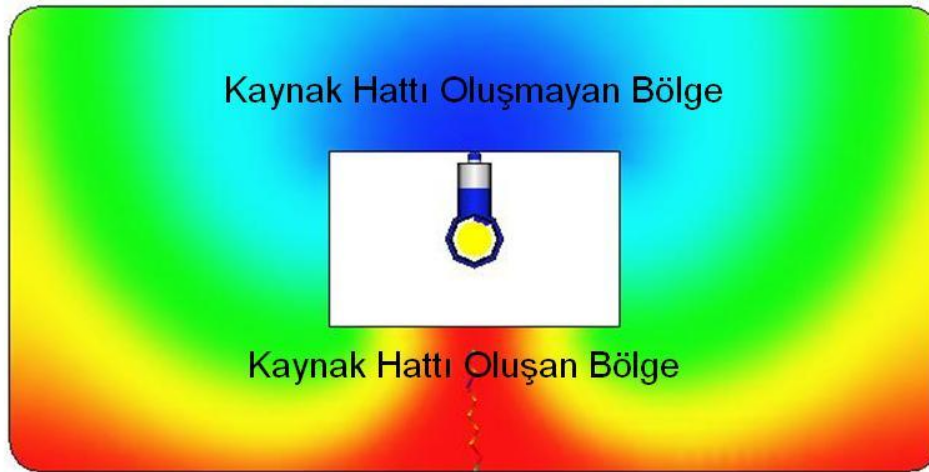
Şekil 6.34. 1 Numaralı Parçanın Dolum Analizi ve Kaynak Hattı Sonucu.
