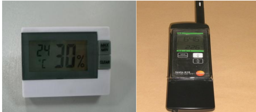
Şekil 8.2. Hücre içerisindeki bağıl nemin kontrolü için kullanılan (solda) TFA marka termo- higrometre, (sağda) Testo 615 termo- higrometre.
