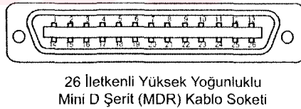
Şekil 2.9. Camera Link bağlantı fişi (3M, MDR 26)
