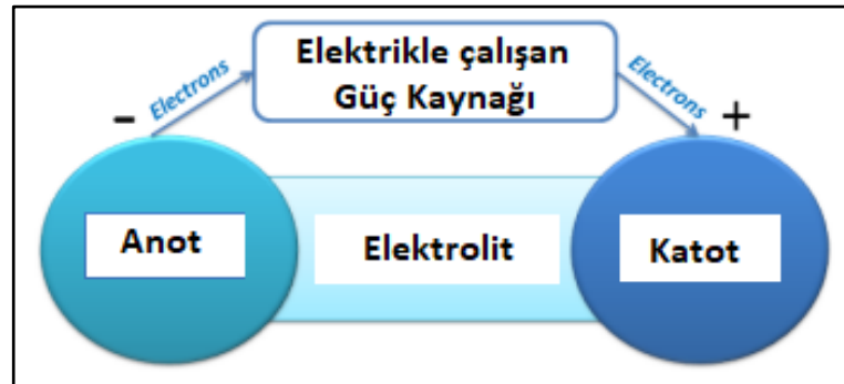
Şekil 1.3: Bir pilin temel parçaları.
