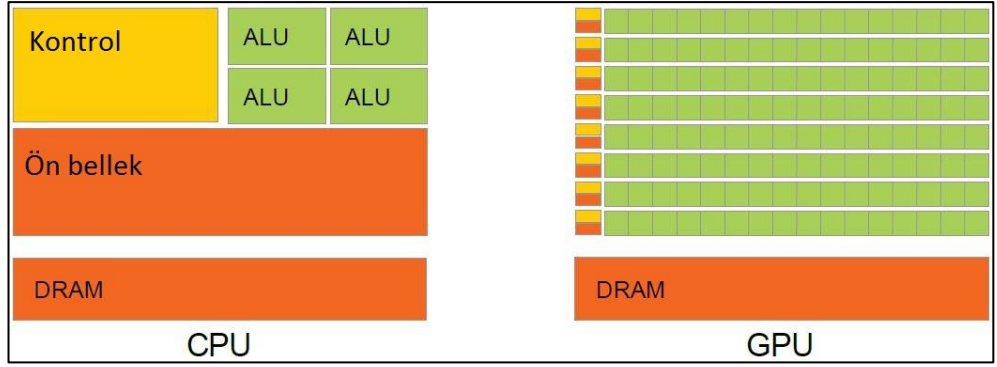
Şekil 3.2: CPU-GPU temel mimari yaklaşımı.
