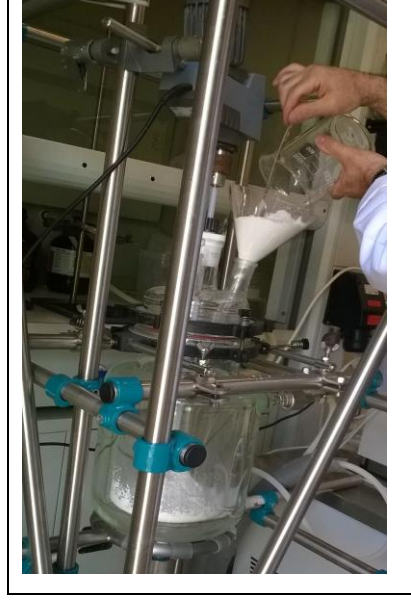
Şekil 3.2: Reaktörde MCC ilavesi görüntüsü.
