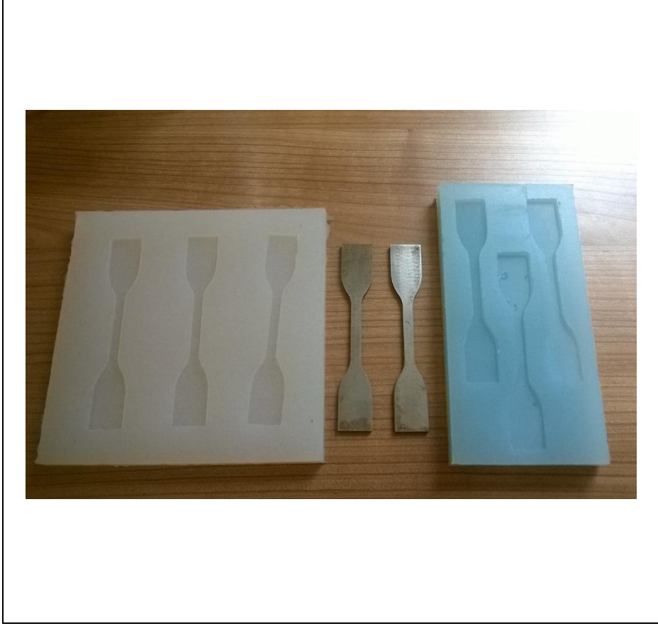
Şekil 3.5: Kompozit malzeme hazırlama çalışmalarında kullanılan silikon kalıplar.
