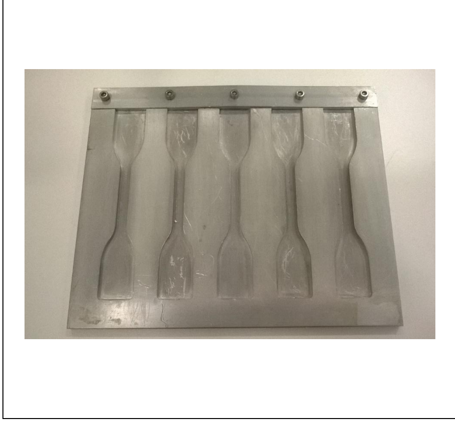
Şekil 3.6: Kompozit malzeme hazırlama çalışmalarında kullanılan metal kalıp.
