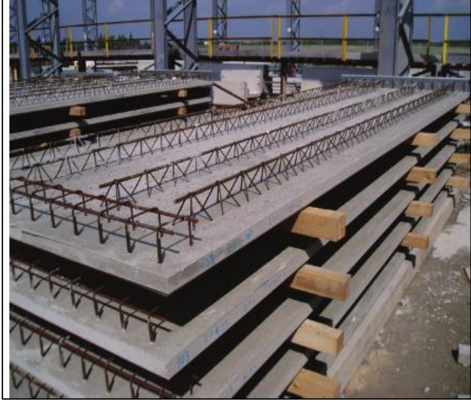
Şekil 2.10: Prefabrik filigran döşeme.
