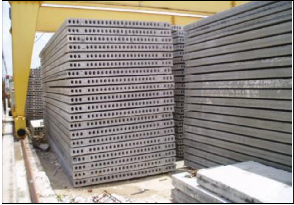
Şekil 2.9: Prefabrik boşluklu döşeme.
