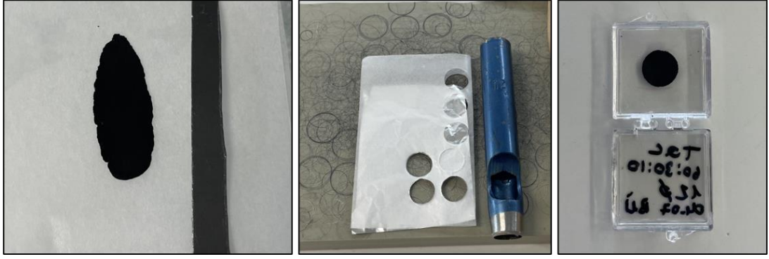
Şekil 3.2: Kendi kendine duran (free-standing) elektrotların hazırlanması.
