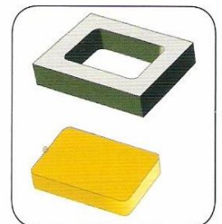
9.- Pişen kauçuğu kauçuk pişirme kalıbından çıkarın ve oda sıcaklığında yaklaşık 25 dakika bekletin, daha sonra neşterle kesip ikiye ayırın.
