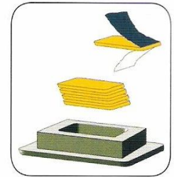
3.- Kauçuğun her iki yüzündeki korumaları sıyırın. Öncelikle gerekli kauçuğu koyun ve elinizle iyice sıkıştırın.
