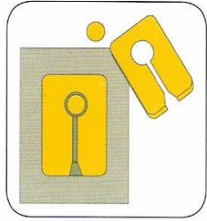
4.- Kauçuğu modele uygun olarak kesin ve kesinlikle hava boşluğu kalmayacak şekilde kalıba yerleştirin.
