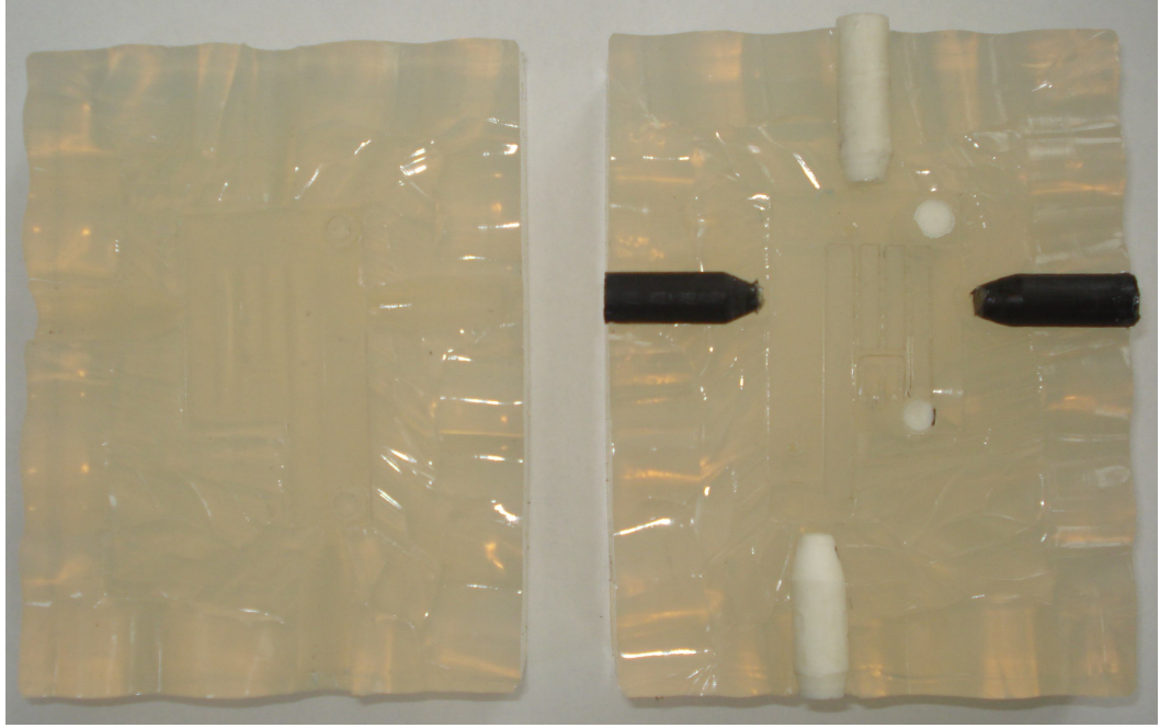
Şekil 5.3. Kalıp ve yolluk giriş yerleri (açık halde)
