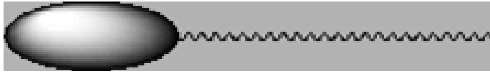
Şekil 2.19 Amfifilik molekül Yapısı
