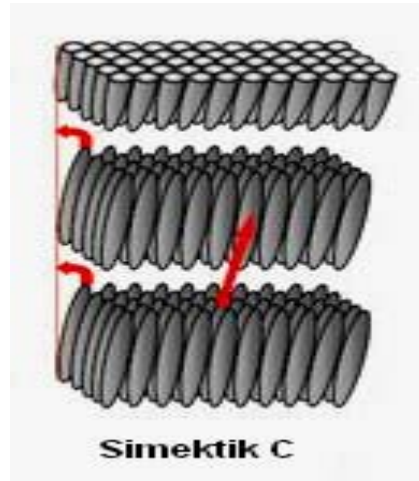
Şekil 2.17 Simektik C Sıvı Kristal Yapısı
