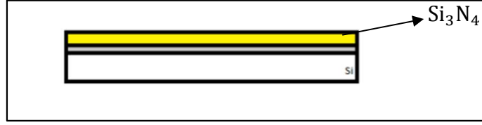
Şekil 4.5: Silisyum Nitrür ( \text{Si}_3\text{N}_4 ) tabakası oluşumu.
