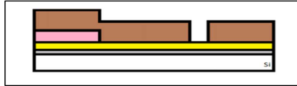
Şekil 4.9: LPCVD Oksit tabakası aşındırma.
