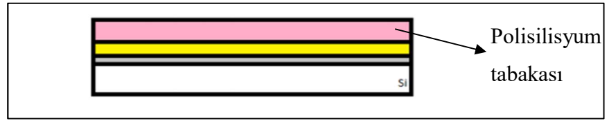
Şekil 4.6: Polisilisyum I tabakası oluşumu.
