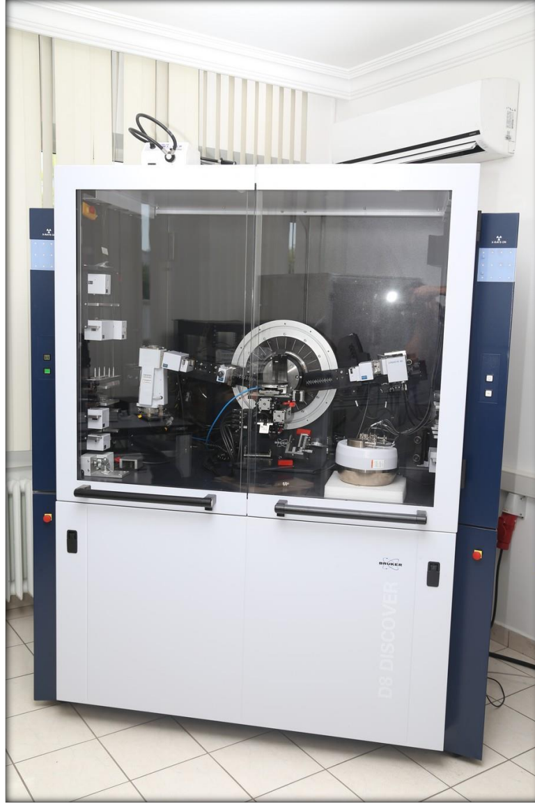
Şekil 3.3: XRD Bruker D8 Discover X-Işını Kırınım Ölçer Cihazı.
