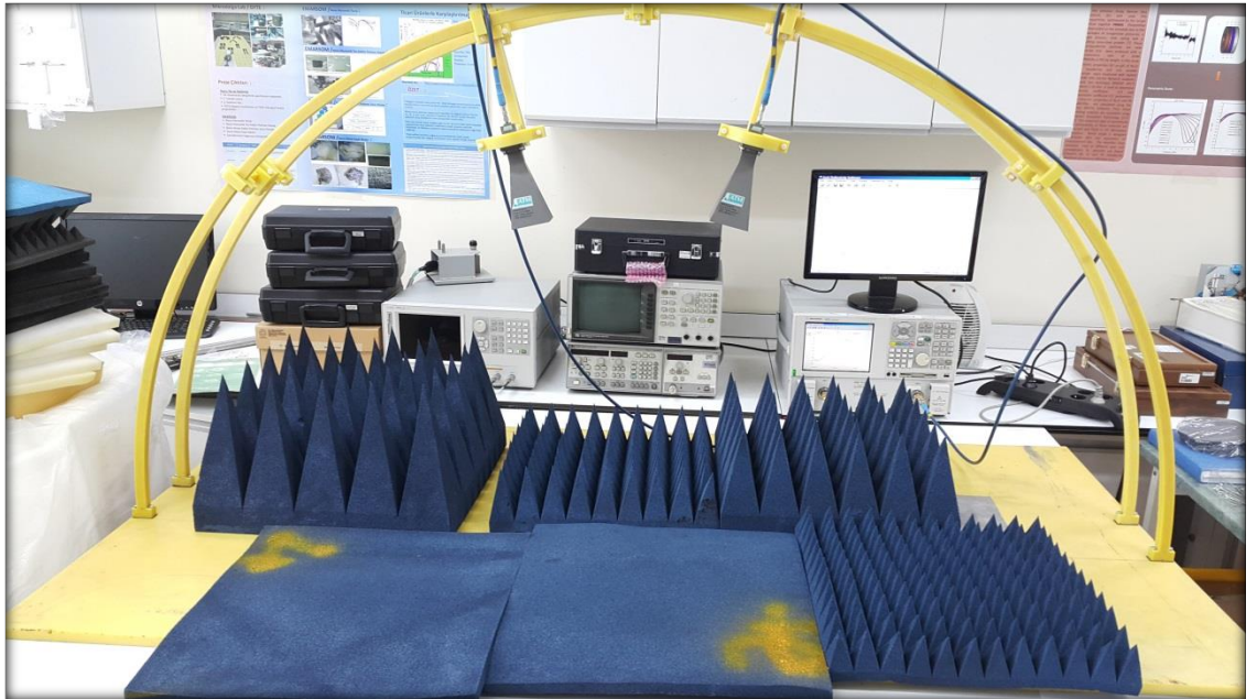
Şekil Ek-A1.4: Farklı şekil ve ebatlardaki mikrodalga soğurucu süngerler.
