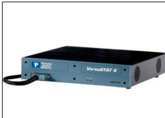
Şekil 3.1: CV denemelerinde kullanılan VersaSTAT3 (Princeton Applied Research) potansiyostat.
